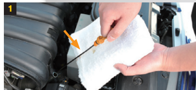
1 平らな場所でエンジンを止めた状態で、オイルレベルゲージを抜き取ります。
